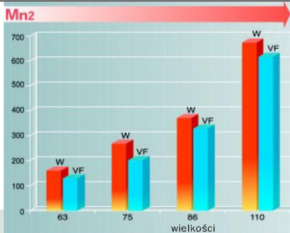
Rys. 6. Porównanie momentu na wału wyjściowym w Nm dla motoreduktorów ślimakowych serii „W” i serii „VF”
