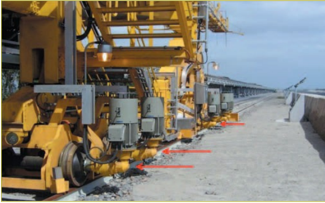
Rys. 6 Napęd jazdy – przekładnie planetarne mocowane bezpośrednio na osiach napędzanych kół jezdnych
