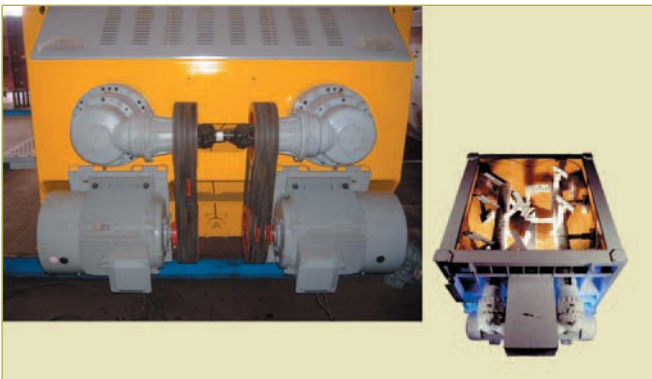
Rys. 7 Napęd mieszalnika z synchronizacją mechaniczną
